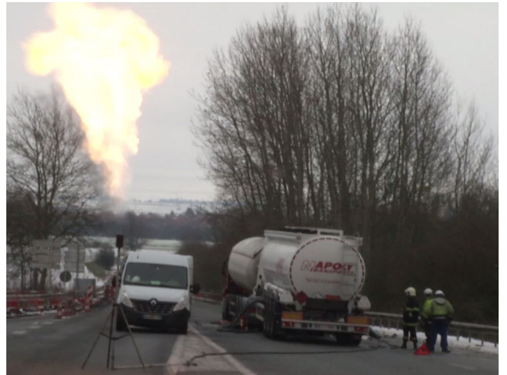
Torchère mise en place afin de vidanger la citerne de propane
