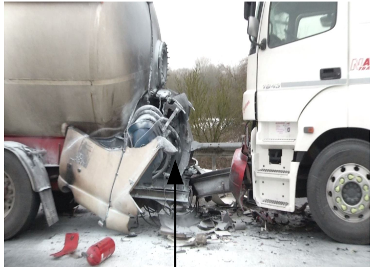
Fuite de propane
